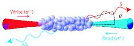
量子存储可以将光的量子态存储于原子系综的自旋波激发态中,是量子中继器的关键部件。由于退相干机制的存在,使得已实现的量子存储的寿命都非常短,只有10微秒左右,这极大地限制了量子中继器在远距离量子通信中的实际应用。通常认为,短的存储寿命是由存储量子态的自旋波在梯度磁场下退相干所造成的。潘建伟研究小组通过对量子存储退相干机制的详细研究,发现除了磁场的影响之外,原子热运动造成的自旋波的失相也是导致量子存
